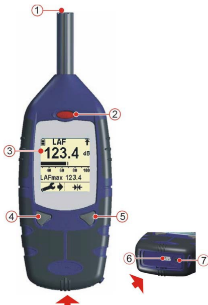
Рис. 1.78. Общий вид прибора Testo 816: 1 – микрофон; 2 – Вкл / Выкл; 3 – дисплей; 4 – левая кнопка; 5 – правая кнопка; 6 – разъем USB; 7 – разъем для гарнитуры (стерео, 2,5 мм)
