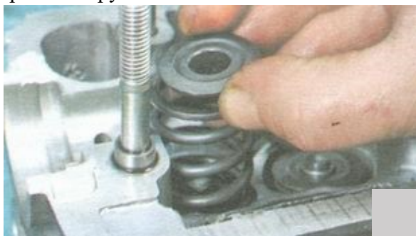
Рис. 1.27. Верхняя тарелка пружины клапана
