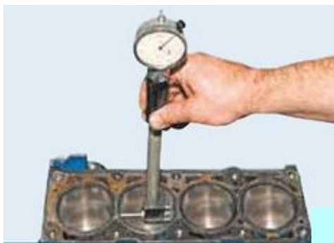
Рис. 1.19. Измерение нутромером диаметра цилиндра
