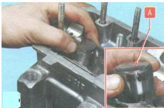
Рис. 1.23. Толкатели клапанов
