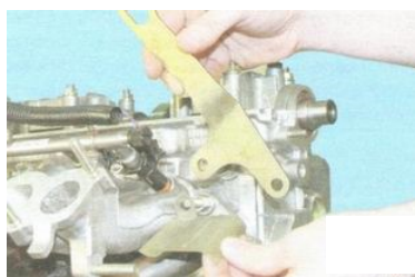
Рис. 1.2. Две гайки крепления переднего теплоизоляционного щитка ( а ) и транспортного рыма ( б )
