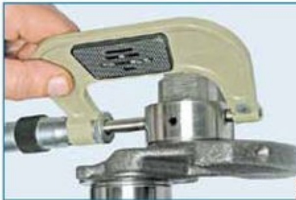
Рис. 1.20. Измерение микрометром диаметров шеек коленчатого вала
