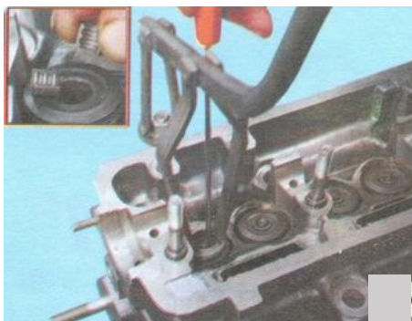
Рис. 1.26. Приспособление для сжатия пружин
