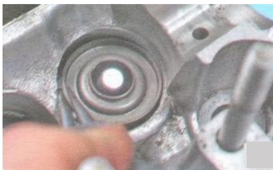
Рис. 1.29. Седка клапанов
