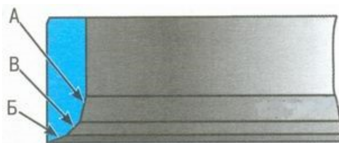
Рис. 1.32. Места притирки (обработки) фасок седел клапанов
