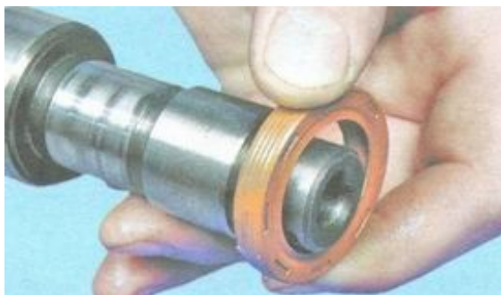
Рис. 1.22. Сальник с распределительного вала
